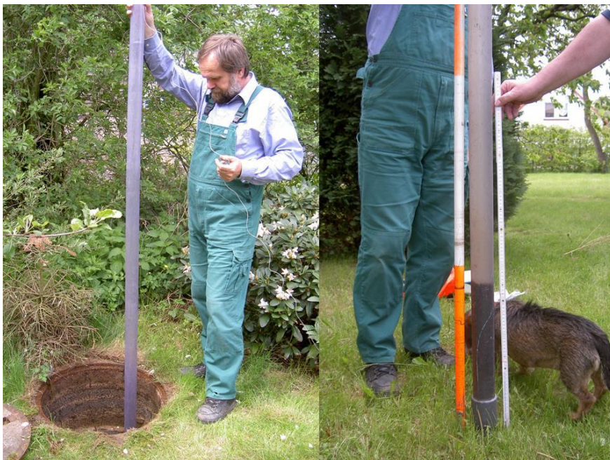
Abb. 38: Schlammspiegelmessung Zum Windfang 3 in Zaatzke ( Mai 2005)
