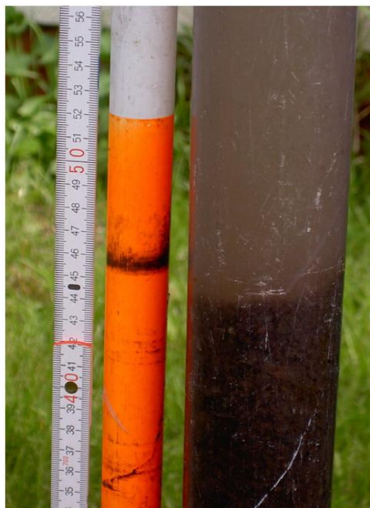
Abb. 39: Schlammspiegelmessungen Zum Windfang 3 in Zatzke (2005)
